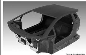
Châssis monocoque de Lamborghini Aventador LP 700-4
