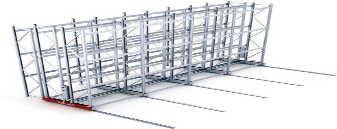
Le rayonnage à étagères ou à palettes qui supporte le produit se déplace avec des galets d'acier sur des rails en profilés acier qui peuvent être ou non encastrés dans le sol. On utilise de telles solutions lorsque le coût du mètre carré de stockage est très élevé et que les articles ont peu de mouvements, (Ex. : archives)
