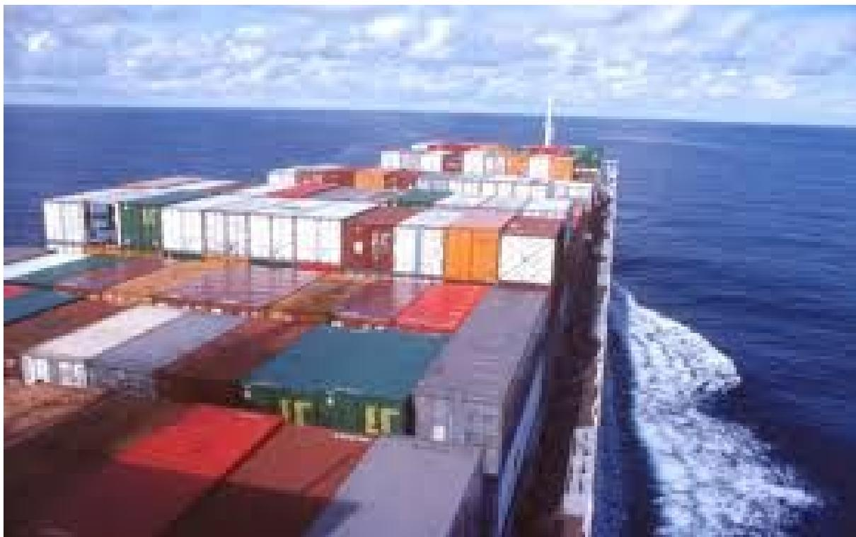
C'est est un emballage de transport ayant un caractère permanent et suffisamment résistant pour permettre un usage répété, spécialement conçu pour faciliter le transport des marchandises sans ruptures de charge par un ou plusieurs moyens de transport. Il est muni de dispositifs le rendant facile à manipuler notamment lors de son transbordement d'un moyen de transport à l'autre. Il est conçu de façon à être facile à empoter (remplissage du conteneur) et à vider.
