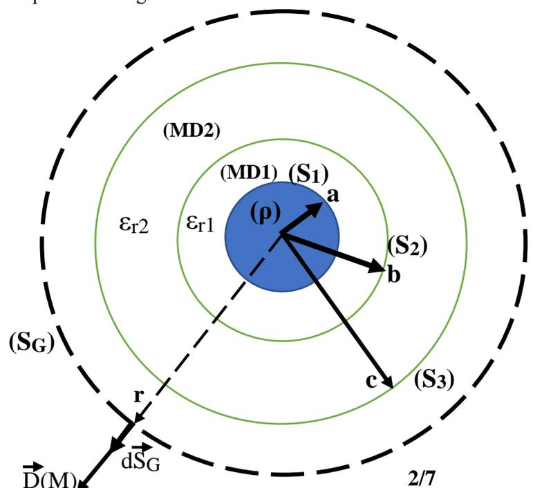
$$\oiint_{(S_G)} \vec{D}(M) \cdot d\vec{S}_G = \oiint_{(S_G)} D(r) \cdot \vec{e}_r \cdot dS_G \cdot \vec{e}_r = \oiint_{(S_G)} D(r) \cdot dS_G = D(r) \cdot \oiint_{(S_G)} dS_G = D(r) \cdot 4\pi \cdot r^2 = Q_{\text{tot}}^{\text{réelle}}$$
