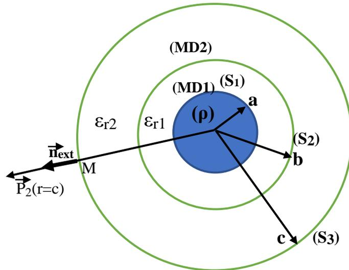
•Densité surfacique de charge de polarisation au niveau de la surface (S<sub>2</sub>) de rayon b commune aux milieux MD1 et MD2 :
