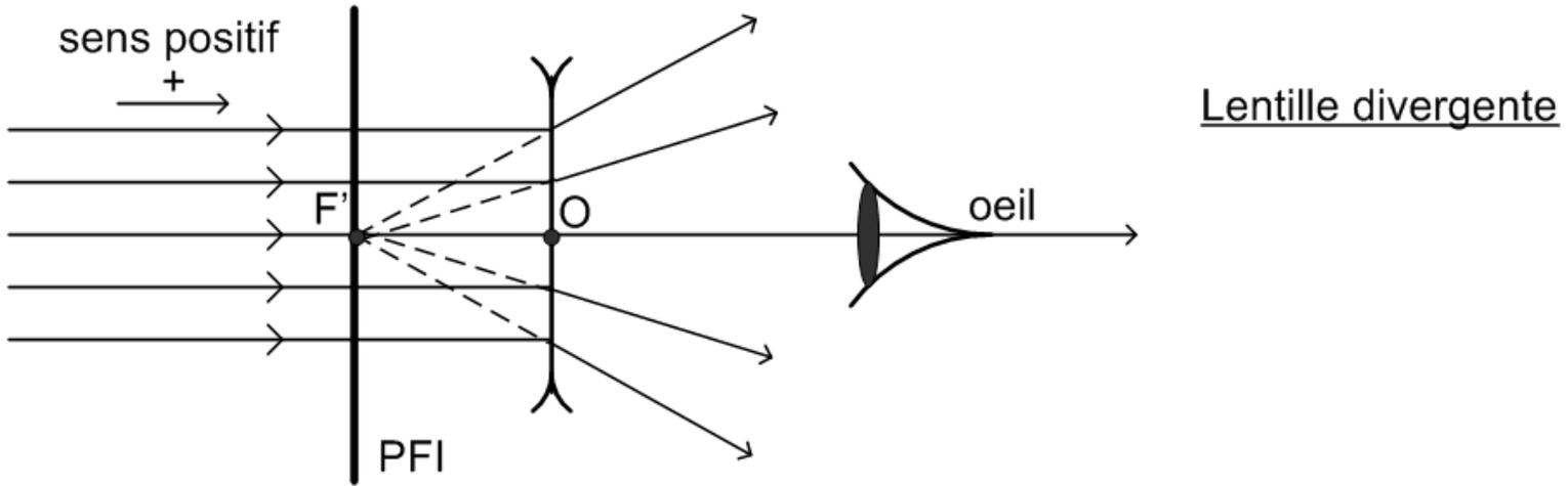
Les rayons sont maintenant déviés vers l'extérieur, mais ils semblent provenir d'un point F' situé cette fois en amont de la lentille. Les rayons réfractés forment un faisceau divergent après la lentille.
