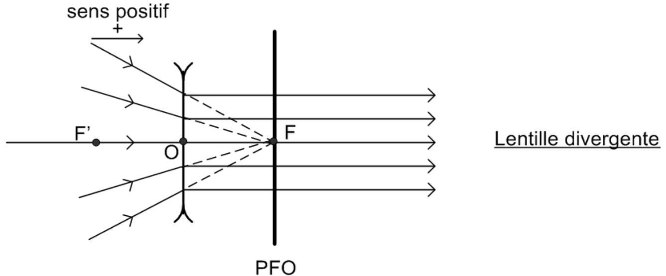
Le foyer objet F de la lentille divergente est **virtuel** : on ne le voit pas sur une feuille de papier placée dans le PFO (on voit un faisceau circulaire). Il n'y a pas de moyen simple pour visualiser ou observer F.
