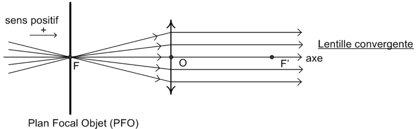
Le point  $F$  s'appelle le foyer objet, le plan perpendiculaire à l'axe en  $F$  s'appelle le Plan Focal Objet, noté PFO, et  $\overline{OF} = f = \text{distance focale objet}$ .
