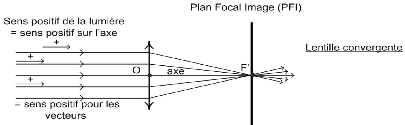
Pour une lentille convergente, le point  $F'$  est en aval de la lentille. Le plan perpendiculaire à l'axe passant par  $F'$  s'appelle le Plan Focal Image, **noté PFI**.
