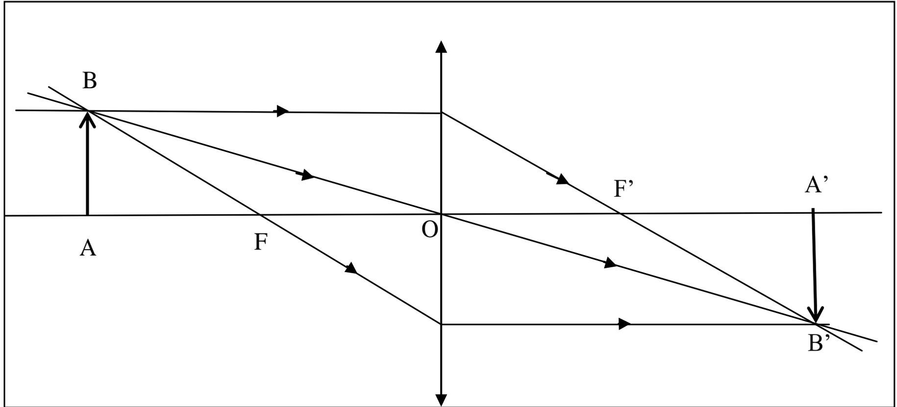
Dans ce cas l'image se forme après la face de sortie de l'instrument d'optique (dans le sens de parcours de la lumière). Elle peut être visualisée sur un écran, on dit que **l'image est réelle**.
