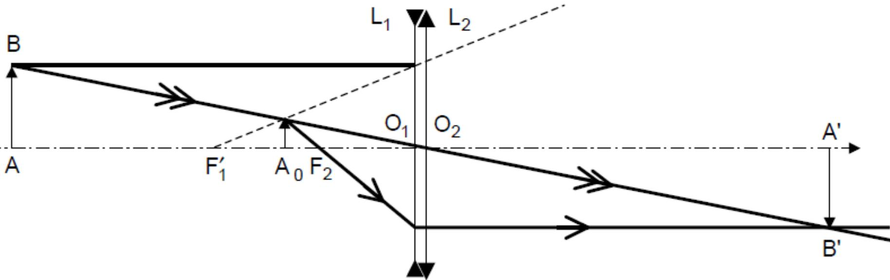
Le diagramme de définition de l'image A'B' de l'objet AB à travers le doublet (L<sub>1</sub>,L<sub>2</sub>) se présente comme suit :
