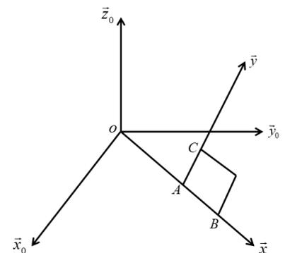
On définit le repère intermédiaire  $R_1(A, \vec{x}, \vec{u}, \vec{z}_0)$  par rapport  $A(x, y, 0)$  dans  $R_0$ ,  $\vec{x}$  unitaire de  $\vec{AB}$  et on pose  $\psi = (\vec{x}_0, \vec{y}_0)$  et  $\theta = (\vec{u}, \vec{AC})$
