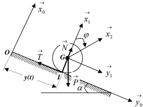
A l'instant initial, le disque est immobile. La réaction au point de contact entre le disque et le plan incliné a deux composantes, l'une normale  $\vec{N}$  au plan incliné, l'autre  $\vec{T}$  tangentielle à ce dernier.
