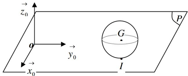
Soit  $R(G, \vec{x}, \vec{y}, \vec{z})$  un repère orthonormé direct, lié à la sphère tel que :  $\vec{OG} = x\vec{x}_0 + y\vec{y}_0 + a\vec{z}_0$ . L'orientation du repère R par rapport à  $R_0$  se fait par les angles d'Euler classiques  $\psi, \theta$  et  $\varphi$ . On prendra  $R_0$  comme repère de projection.
