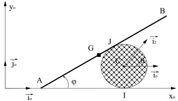
Le solide ( $S_1$ ) est en contact ponctuel avec ( $S_2$ ) en  $J$  et le coefficient de frottement  $f$  entre ( $S_1$ ) et ( $S_2$ ) est tel que ( $S_1$ ) glisse sur ( $S_2$ ).
