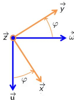
$$\vec{x} = \cos \varphi \vec{u} + \sin \varphi \vec{w} \quad \vec{y} = -\sin \varphi \vec{u} + \cos \varphi \vec{w}$$
