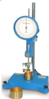
Fig. 10 : Détermination de la limite de liquidité par la méthode du cône de pénétration
