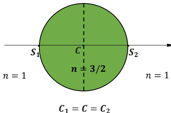
Aussi, il est alors commode d'utiliser la relation de conjugaison **avec origine au centre  $C$** , puisque les deux dioptres possèdent le même centre :  $C_1 = C_2 = C$ .
