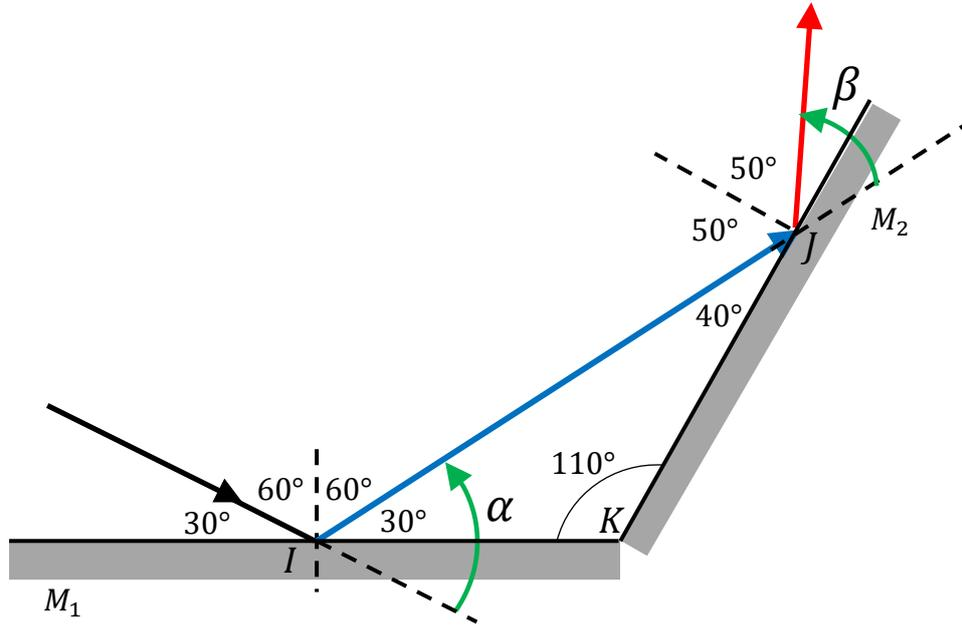
L'angle d'incidence sur  $M_2$  vaut donc  $50^\circ$ , de même que l'angle de réflexion.
