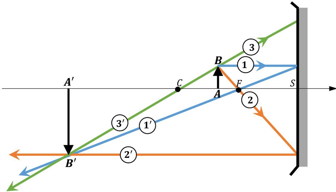
**Figure 3 :** Exercice 14 – **Miroir concave** ( $2f < \overline{SA} < f$ ) – Construction de l'image d'un objet réel situé entre C et F (centre et foyer) d'un miroir concave.
