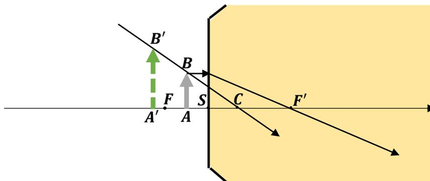
c) Pour  $\overline{SA} = 5 \text{ cm}$  (objet virtuel), on obtient :  $\overline{SA'} = 6 \text{ cm}$ .
