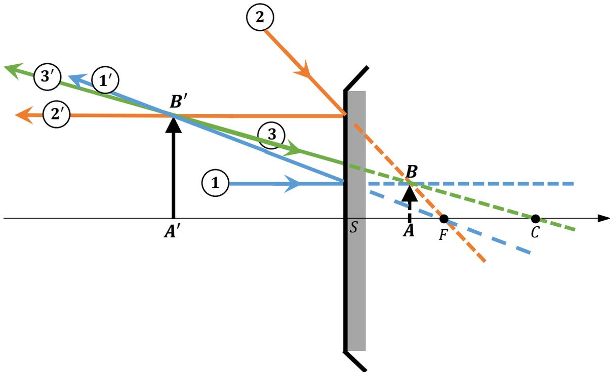
**Figure 4 :** Exercice 14 – **Miroir convexe** ( $0 < \overline{SA} < f$ ) – Construction de l'image d'un objet virtuel situé entre S et F (sommet et foyer) d'un miroir convexe.
