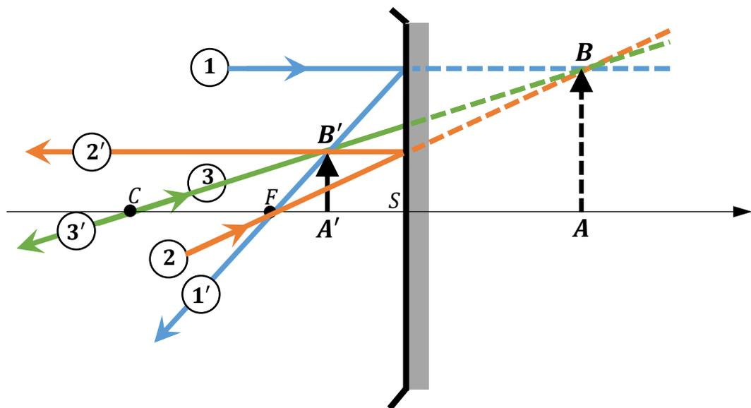
**Figure 1 :** Exercice 14 – **Miroir concave** ( $\overline{SA} > 0$ ) – Construction de l'image d'un objet virtuel.
