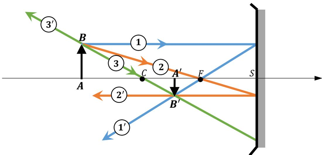
**Figure 2 :** Exercice 14 – **Miroir concave** ( $-\infty < \overline{SA} < 2f$ ) – Construction de l'image d'un objet réel situé avant C (centre) d'un miroir concave.
