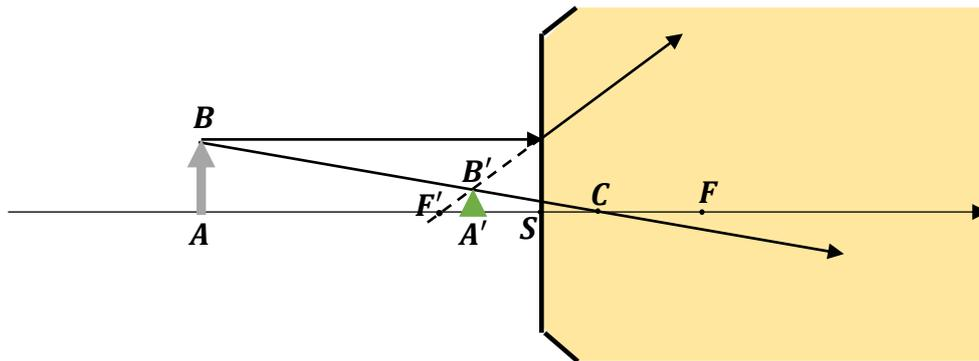
b) Pour  $\overline{SA} = -10 \text{ cm}$  (objet réel), on trouve  $\overline{SA'} = -5 \text{ cm}$ .
