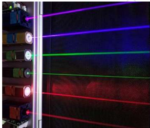
Figure 1 : Lasers semi-conducteurs (De Bas en Haut : 660 nm, 635 nm, 532 nm, 520 nm, 445 nm, 405 nm)
