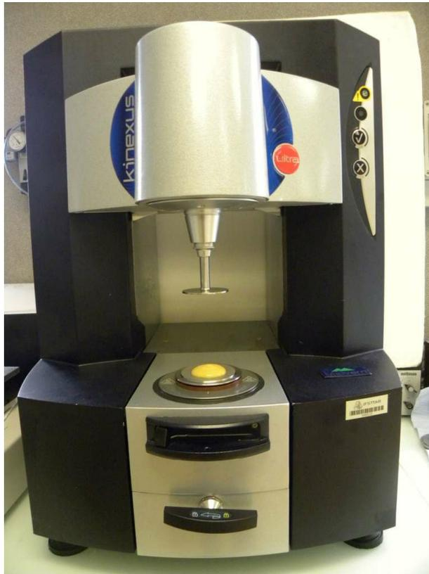
**L'outil privilégié pour mesurer la viscosité d'un liquide est le rhéomètre rotatif, qui utilise diverses géométries de mesure telles que des disques parallèles qui, après s'être rapprochés en écrasant quelque peu l'échantillon, tournent l'un par rapport à l'autre autour du même axe.**
