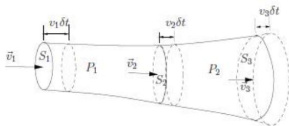
**FIGURE:** Écoulement dans une conduite à section variable de  $S_1$  à  $S_3$  avec  $S_1 < S_2 < S_3$  ; la vitesse étant supposée uniforme à toute section  $S$ .
