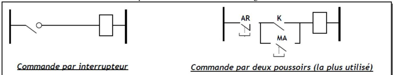
Si on appuie sur le bouton poussoir **MA** la bobine du contacteur est alimentée et ferme le contact **K**. Même si on relâche le bouton poussoir la bobine reste alimentée (**auto-maintien**). Pour couper l'alimentation il suffit d'ouvrir le bouton poussoir **AR**. Généralement, dans une chaîne d'énergie électrique, le pré-actionneur ne s'utilise pas seul, mais associé à une classe d'appareillage typique : sectionneur, relais thermique, etc.
