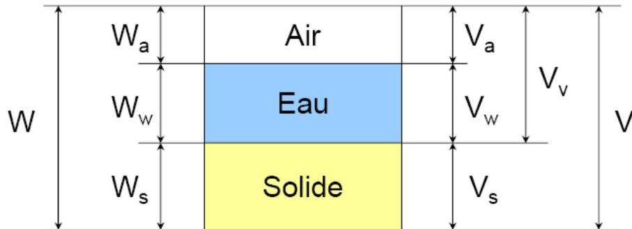
Figure 2 : représentation schématique d'un échantillon de sol
