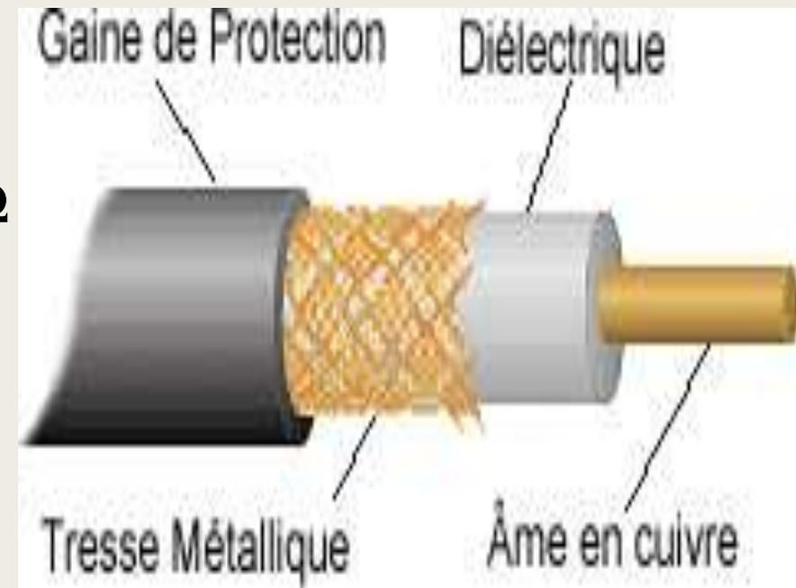
Chaque extrémité du bus est bouclée sur un *bouchon*” dont l'impédance électrique est égale à l'impédance caractéristique du câble.
