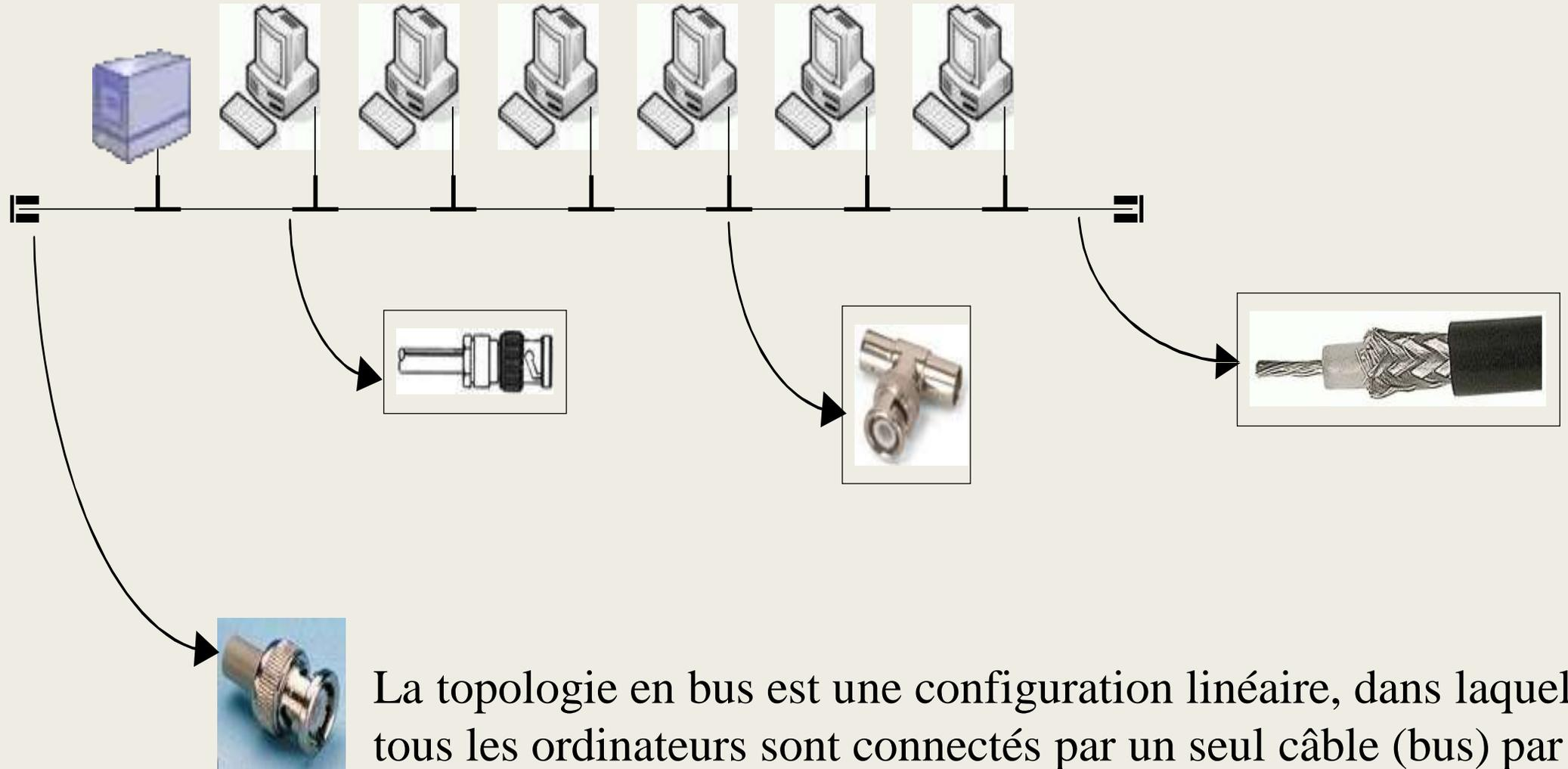
La topologie en bus est une configuration linéaire, dans laquelle tous les ordinateurs sont connectés par un seul câble (bus) par l'intermédiaire d'un connecteur « T »
