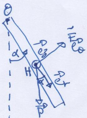
4) Lorsque le bas contact de la barre sort du bain de mercure, on aura un circuit ouvert et la force de Laplace s'annule. Ensuite la barre retombe dans le bain de mercure et on aura à nouveau un circuit fermé et la force de Laplace réapparaît. La barre va osciller pendant un moment jusqu'à ce que la barre se stabilise à la limite du bain de mercure même il va rester des petites oscillations car le contact avec le mercure doit exister.
