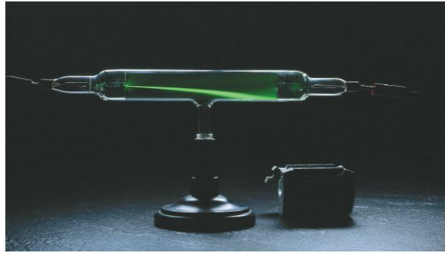
Figure 2. Déviation des rayons cathodiques
