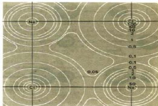
Figure III-5-1 : Densité de la distribution électronique \rho(e/\text{\AA}^3) dans le plan de base de NaCl d'après des études aux rayons X
