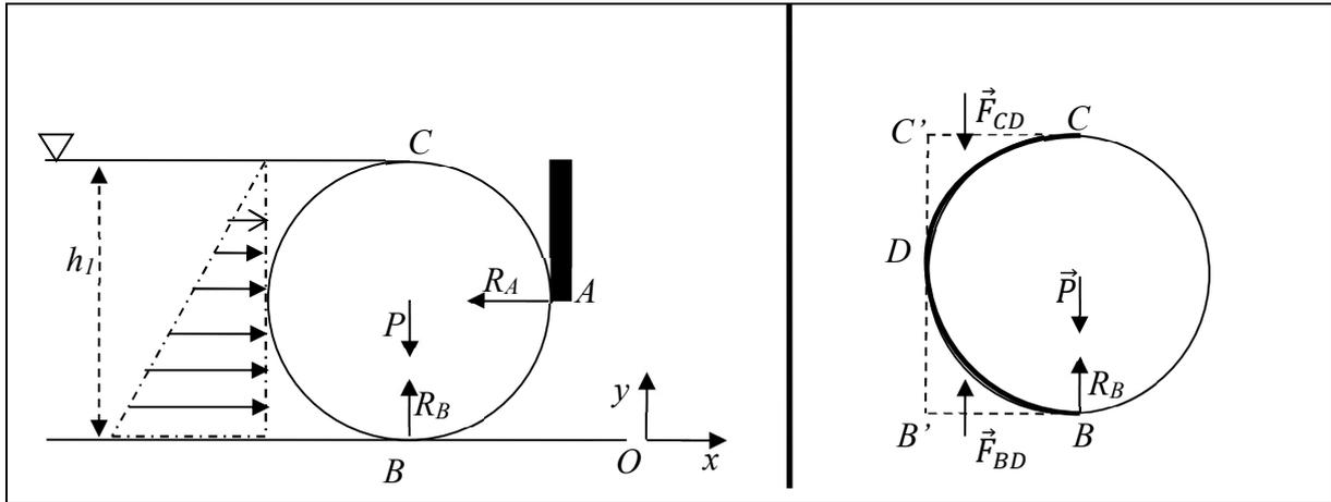
Figure II. 7 Schématisation des forces horizontale et verticale
