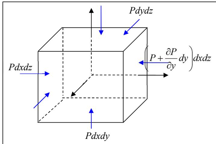
Figure II. 2 L'ensemble de force appliqué à l'élément fluide
