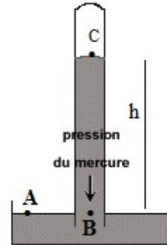
Figure II. 4 Baromètre à Mercure
