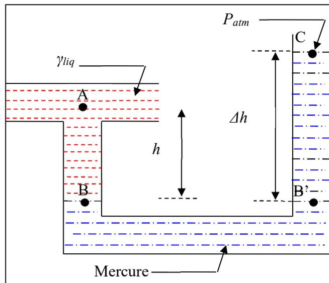
Figure II. 6 Schéma explicatif du piézomètre à liquides différents
