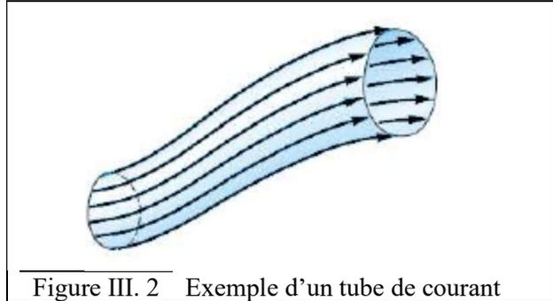
Figure III. 2 Exemple d'un tube de courant
