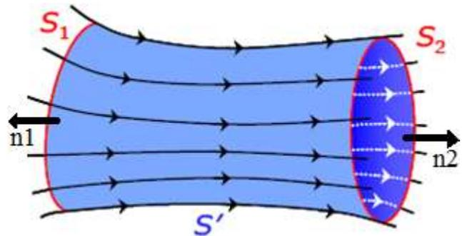
Le tube de courant est infiniment mince de sorte que  $\rho_1$  et  $v_1$  sont constantes sur  $S_1$  de même pour  $S_2$  :
