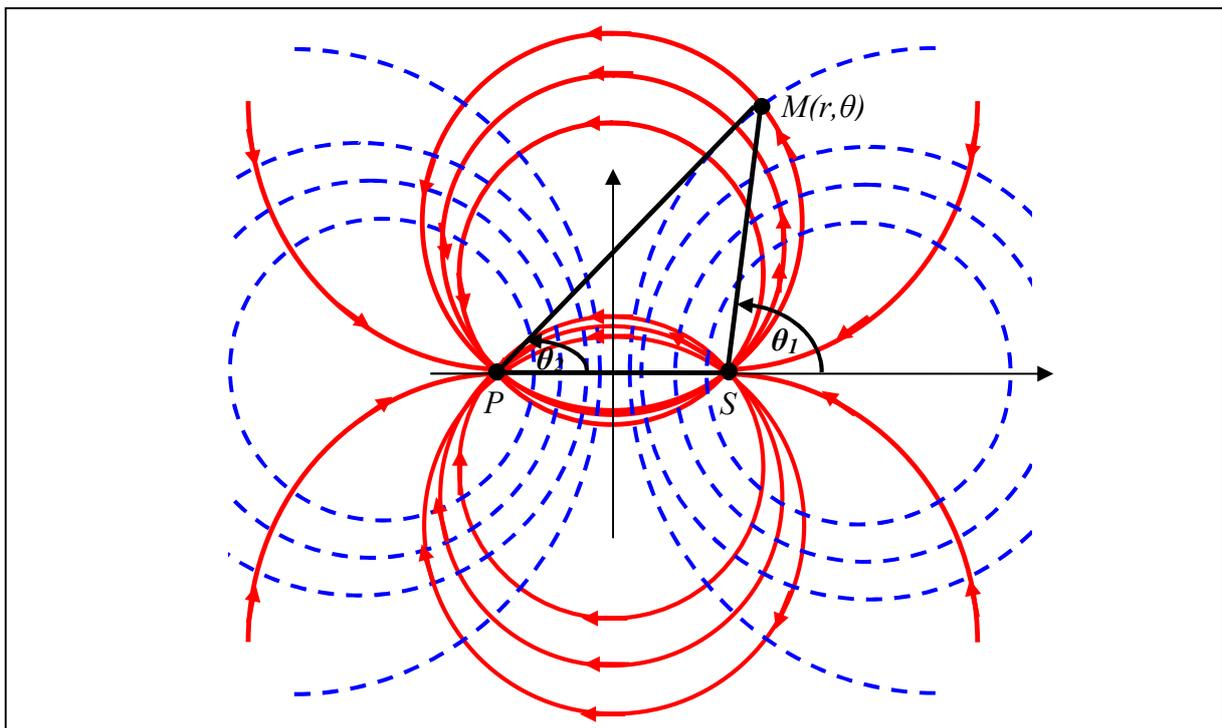
Si on fait tendre  $a$  vers  $0$ , on superpose le puits et la source à l'origine. On crée un dipôle.
