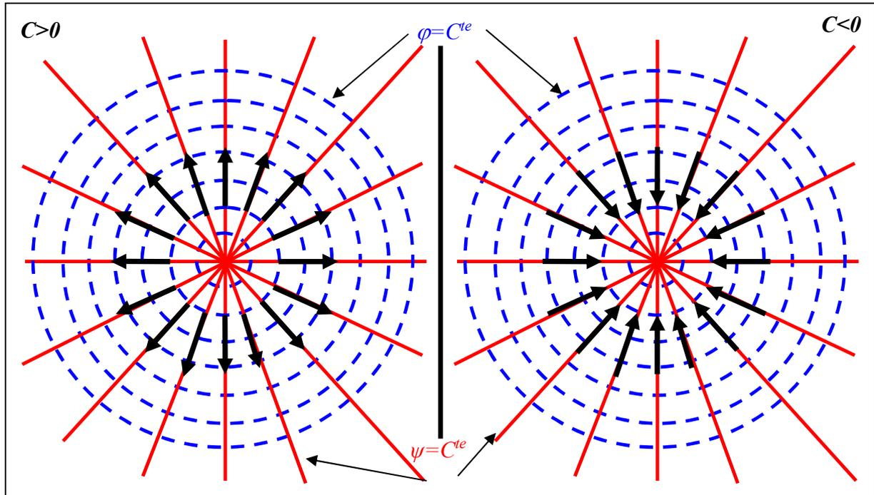
Il s'agit donc d'un écoulement radial centré sur l'origine, où la vitesse est inversement proportionnelle à la distance à l'origine.
