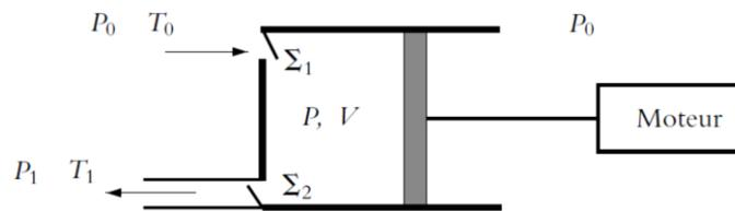
1. **a)** Tracer sur un diagramme de Watt ( $P$  en ordonnée,  $V$  en abscisse) l'allure de la courbe représentant un aller et un retour du piston. Indiquer le sens de parcours par une flèche.
